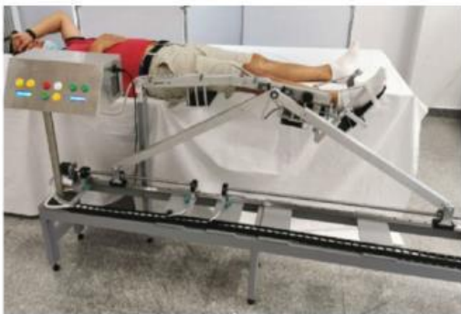
Sistemul robotic RECOVER pentru recuperarea membrului inferior
