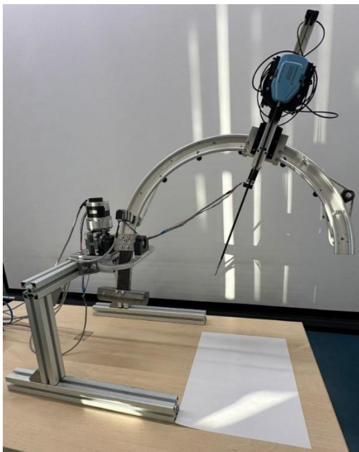
Sistemul robotic PARA-SILSROB dezvoltat pentru chirurgia uniport (CESTER)
